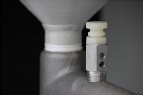
Abb. 6: Dosierventil der Strahldüsen
